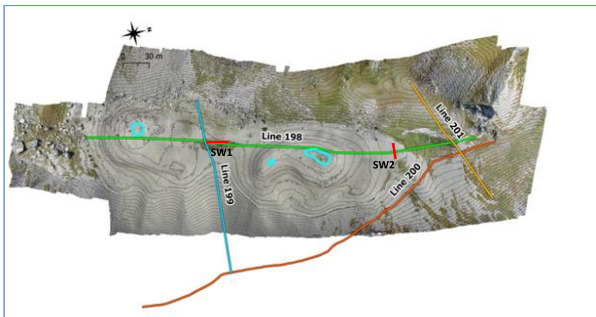
Figura 33: Ubicazione delle linee radar all'interno dell'area di studio (in celeste il perimetro degli specchi d'acqua alla data dell'11/09/2019; in rosso le indagini sismiche in onde superficiali SW1 e SW2 effettuate in precedenza)
